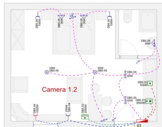
Trasare cabluri cu comanda "Spline"
